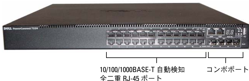
図 1-1. 10/100/1000BASE-T ポートを 24 個備えた PowerConnect 7024
