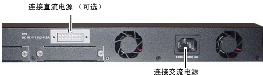
图 1-15. 交换机的交流和直流电源连接
